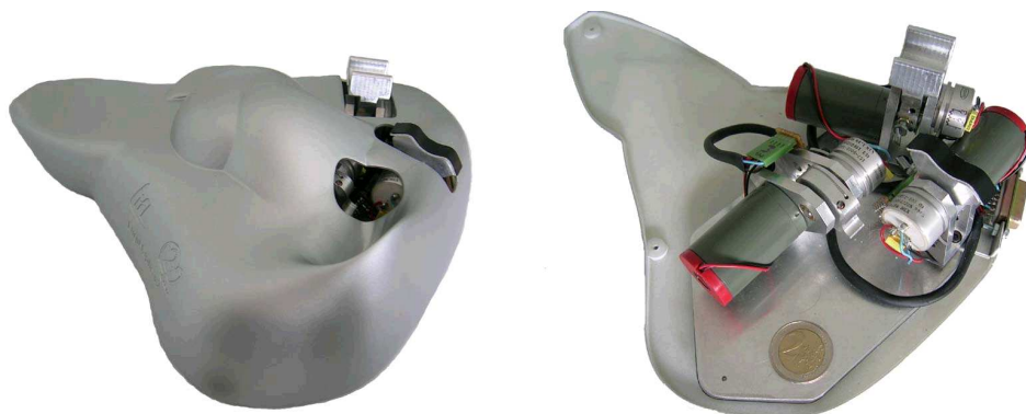
FIG. 4.17 – La version 2 du DigiHaptic avec et sans la coque.
